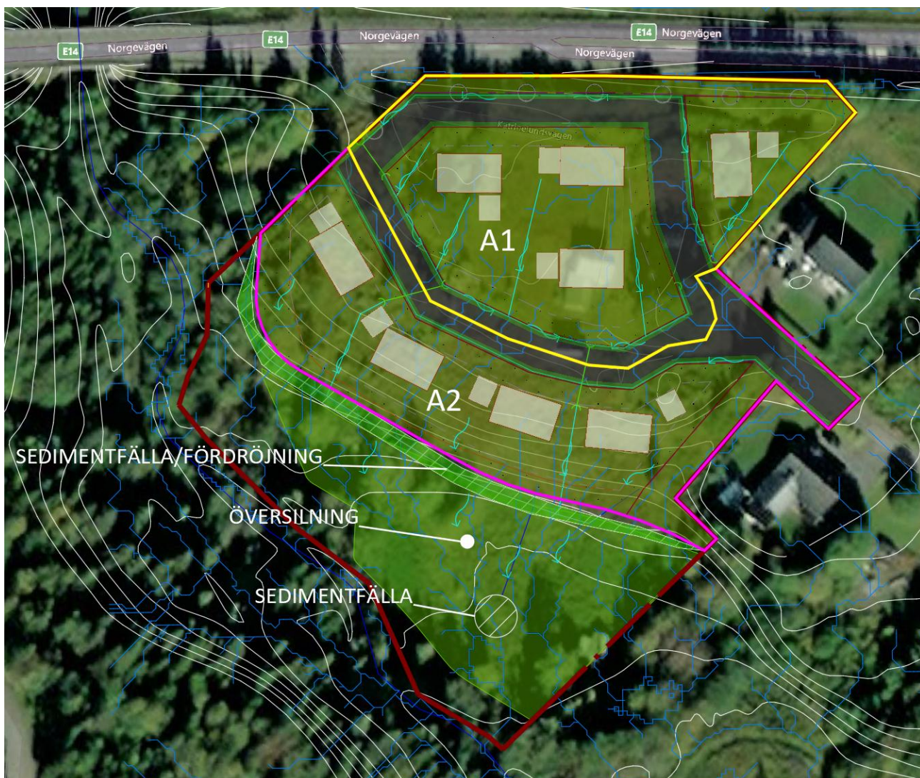
Figur 9. Illustration över föreslagna dagvattenåtgärder. I figuren redovisas utredningsområden (A1-A2), förslag till avrinning utifrån principerna för en planerad höjdsättning, sedimenteringsfällor, krossdiken och översilning. Förslag till lägen för trumgenomföringar är också illustrerade. Grundkarta, förslag till plankarta och ortofoto i bakgrunden.
