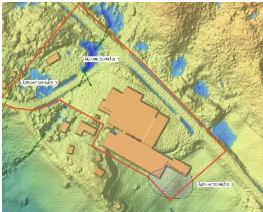
Figur 10. Lågpunktsområden med stående vatten vid 70mm regn.
