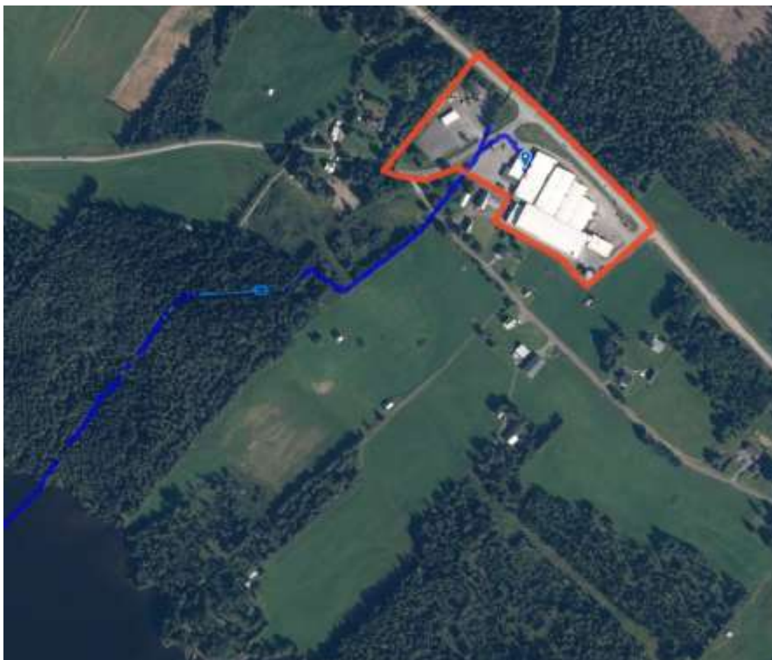
Figur 9. Dagvatten från planområdet leds via dike/bäck till Storsjön.
