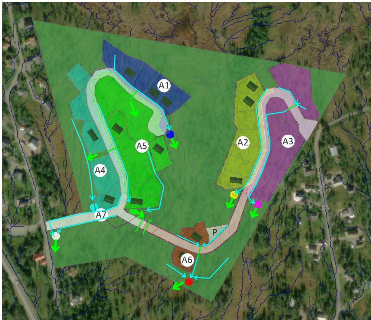
Figur 11. Illustration över föreslagna dagvattenåtgärder.
