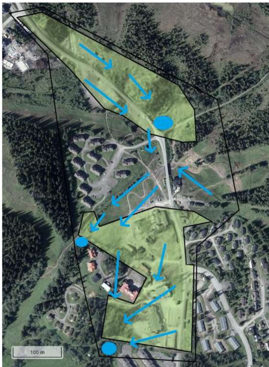
Figur 19. Schematisk dagvattenhantering för planområdet med lämpliga platser för uppsamling (blåmarkerade ytor).
