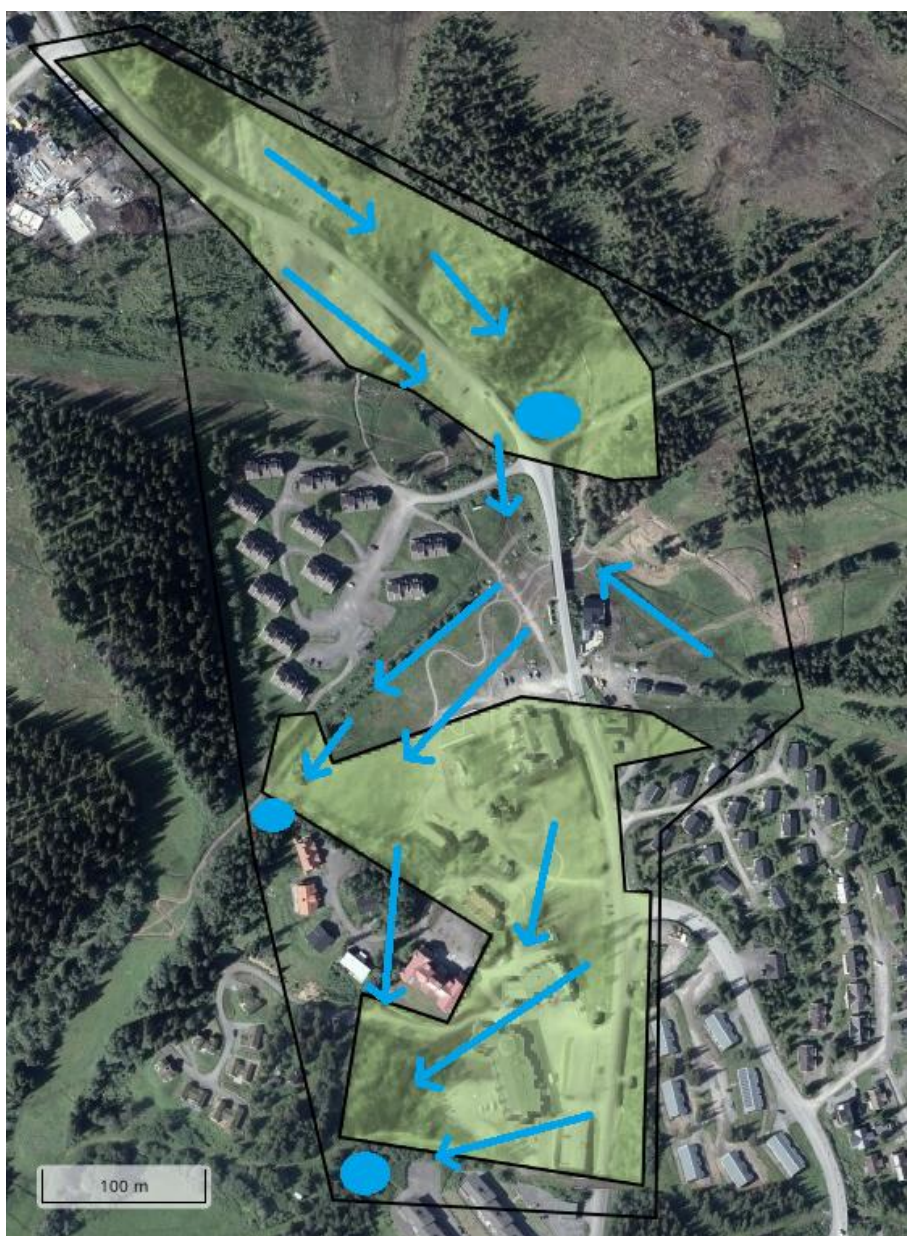
Figur 8. Schematisk dagvattenhantering för planområdet med lämpliga platser för uppsamling (blåmarkerade ytor).
