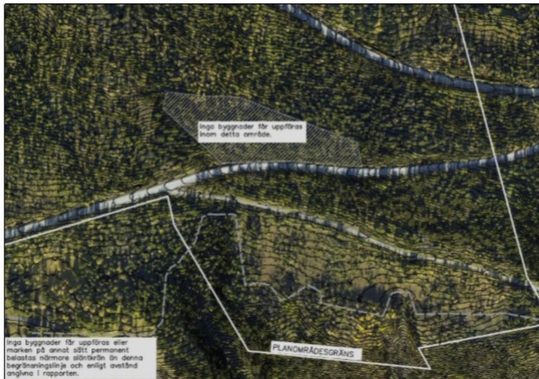
Figur 13. Enligt resultatet som redovisas i Swecos stabilitetsutredningar får inga byggnader uppföras i det skrafferade området i Ullådalsvägens serpentin. Några byggnader eller annan permanent belastning får inte heller uppföras mellan Ullådalsvägen och den streckade linjen. Ett horisontellt skyddsavstånd om minst 45 m ska också hållas i relation till den streckade linjen. Bildkälla: Sweco 2017 B.
