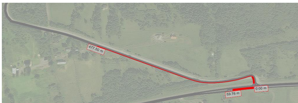
Figur 42 – Maximala kölängden som har registrerats i UA2B med lägre hastighet och lägre trafikflöde (Test 1)
