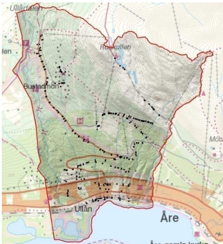
Figur 15. Simulerade trummor (svarta punkter indikerar trummornas in- och utlopp).
