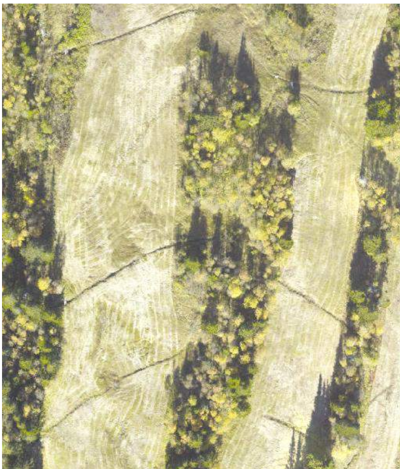
Figur 71. Exempel på avskärande diken längs befintliga skidnedfarter i Åre.
